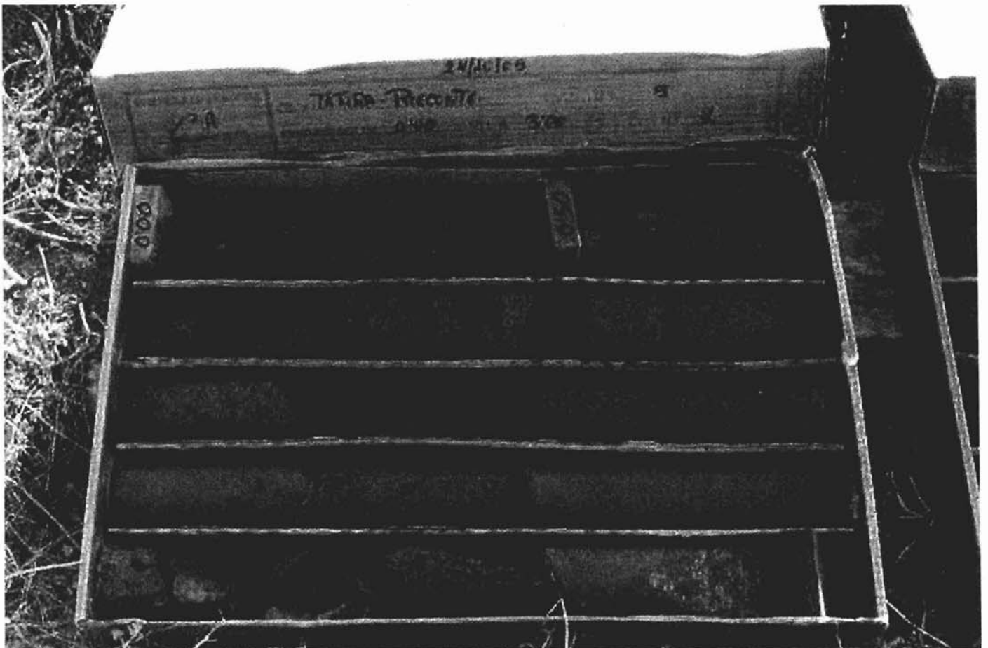
FOTO N°12: Testigos del sondeo número 5, comprendidos entre 0.00 y 3.00m.
