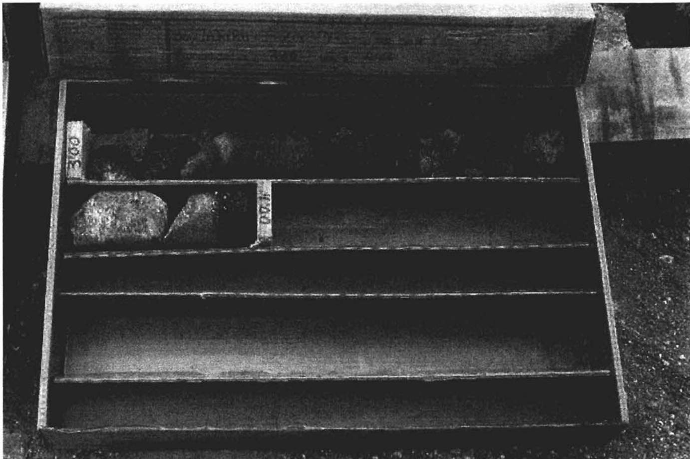
FOTO N°5: Testigos del sondeo número 1, comprendidos entre 3.00 y 4.00m.
