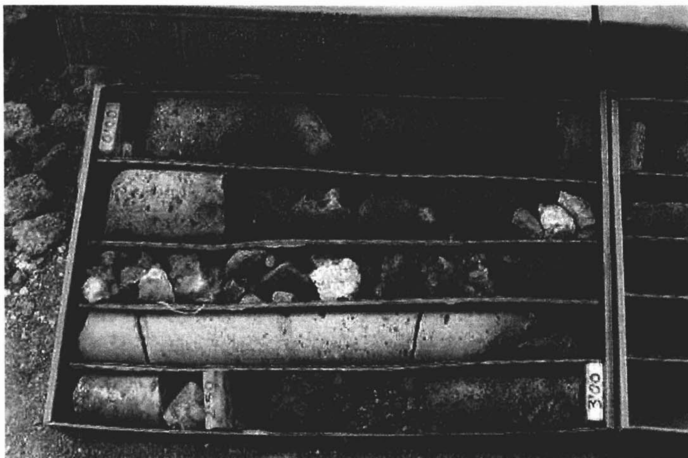
FOTO N°6: Testigos del sondeo número 2, comprendidos entre 0.00 y 3.00m.
